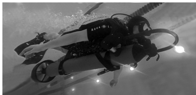
Рис. 4. Размещение водолаза на буксировщике «Фактор»
