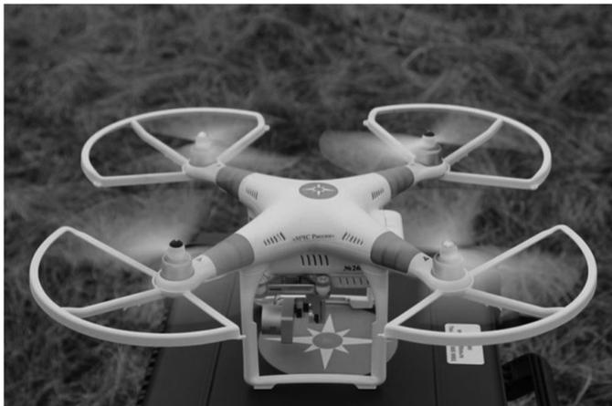
**Рис. 1.** БПЛА DJI Phantom 3, применяемый для обнаружения лесных пожаров сотрудниками МЧС России в РК
